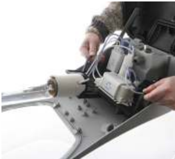
Sposób demontażu osprzętu elektrycznego
